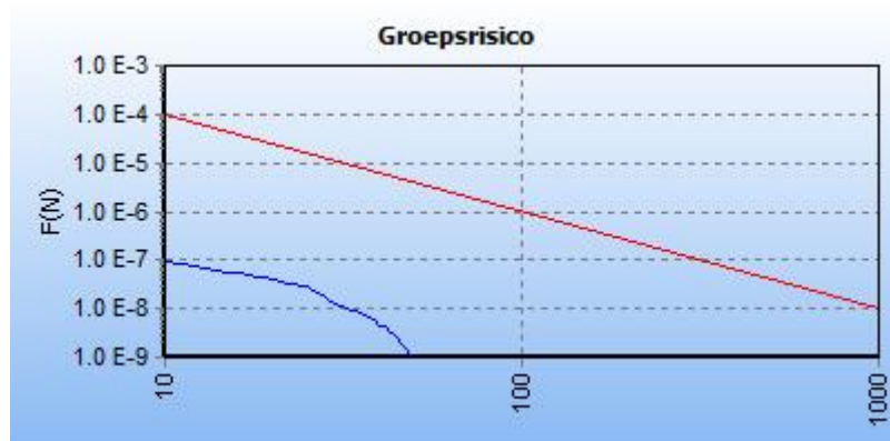
5.1 Figuur 5.1 FN curve voor 9141_leiding-N-501-25-deel-1 van N.V. Nederlandse Gasunie voor de kilometer tussen stationing 2190.00 en stationing 3190.00
