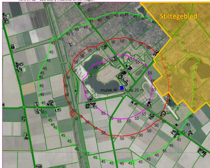
Figuur 2: overzicht van de berekende (indicatieve) geluidcontouren op basis van 90 dB(A) op 25 m afstand van de luidsprekers en L_w = 128 dB(A) muziekbronvermogen
