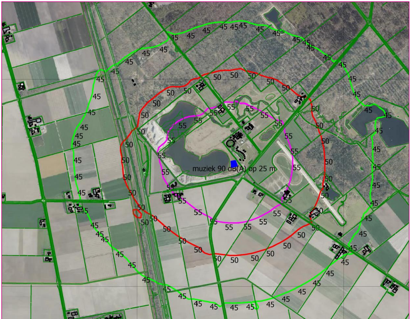
Figuur 2: overzicht van de berekende (indicatieve) geluidcontouren op basis van 90 dB(A) op 25 m afstand van de luidsprekers en L_w = 128 dB(A) muziekbronvermogen
