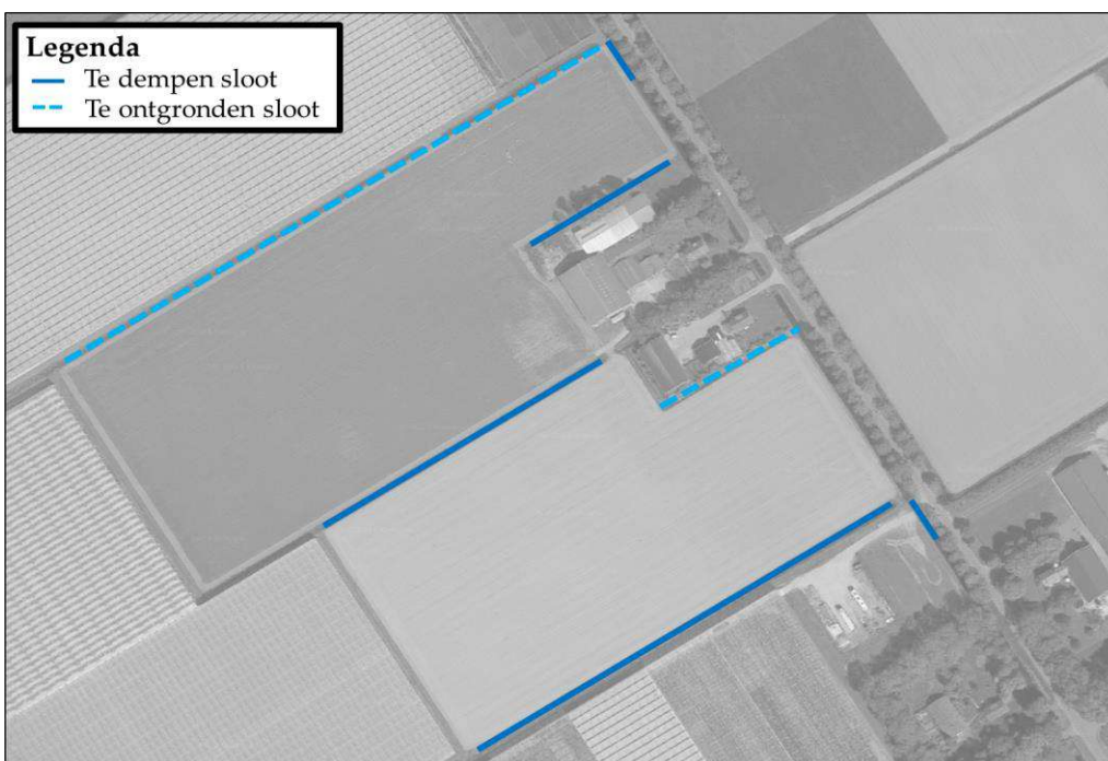
Figuur 2 Binnen de planlocatie zullen (delen van) sloten gedempt worden en één sloot ontgrond worden.
