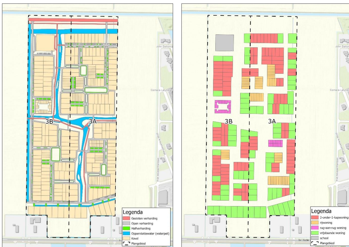
Afbeelding 8: Verhard oppervlak wegen en kavels per fase, en verdeling type kavels
