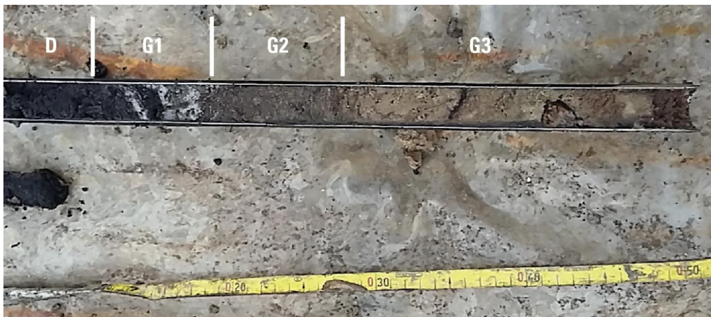
Fig. 3.3. Detailfoto van het bodemprofiel in het dekzand in boring 20. Voor legenda zie figuur 3.2.
