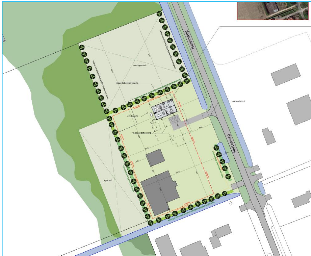
Figuur 3.8: Erfinrichting tekening van het plangebied met een vier meter brede zone met een fruitbomensingel van twee meter en een onderhoudsstrook van twee meter.
