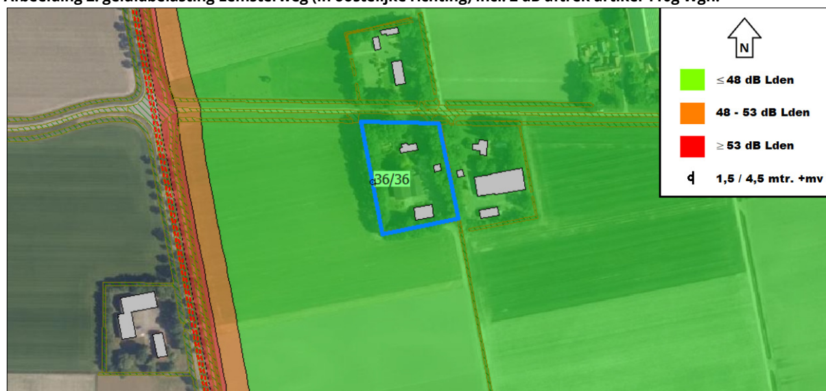
Afbeelding 2: geluidbelasting Lemsterweg (in oostelijke richting) incl. 2 dB aftrek artikel 110g Wgh.
