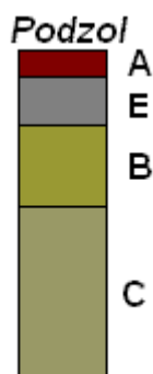
Afbeelding 3. Schematische weergave van een podzolbodem
