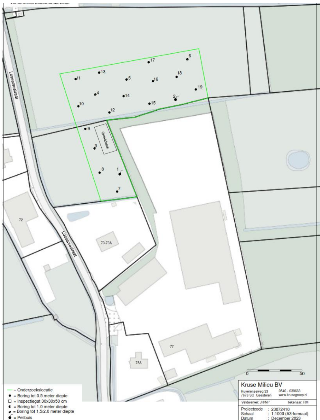
Afbeelding 7.2 Boorplan onderzoek locatie (Bron: Sigma Geo-en Milieutechniek)
