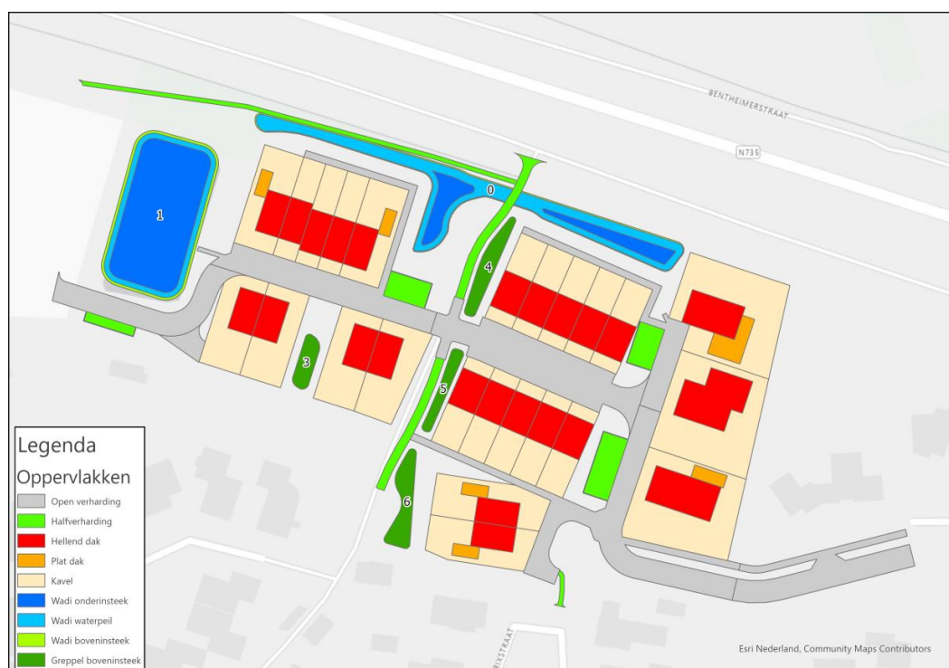
Afbeelding 3.2: Afvoer goten naar wadi's
