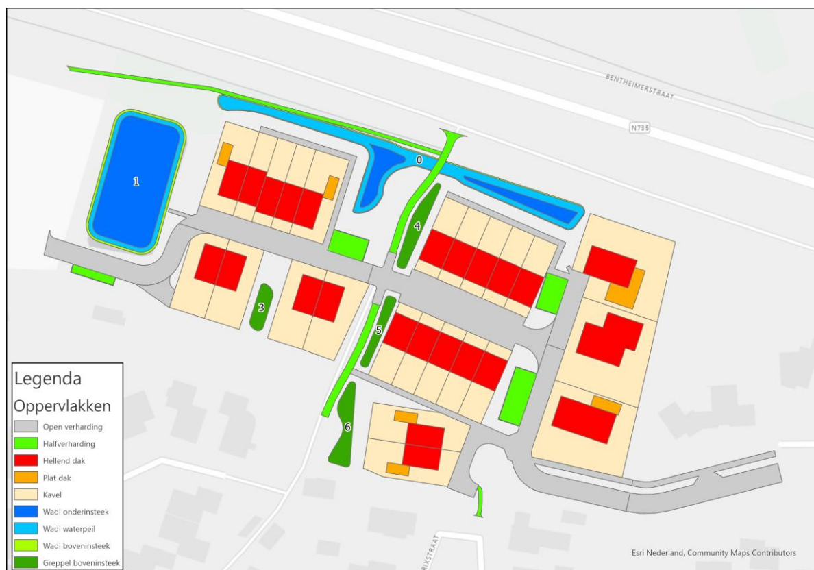
Afbeelding 3.1: Waterberging en vertraagd afvoeren
