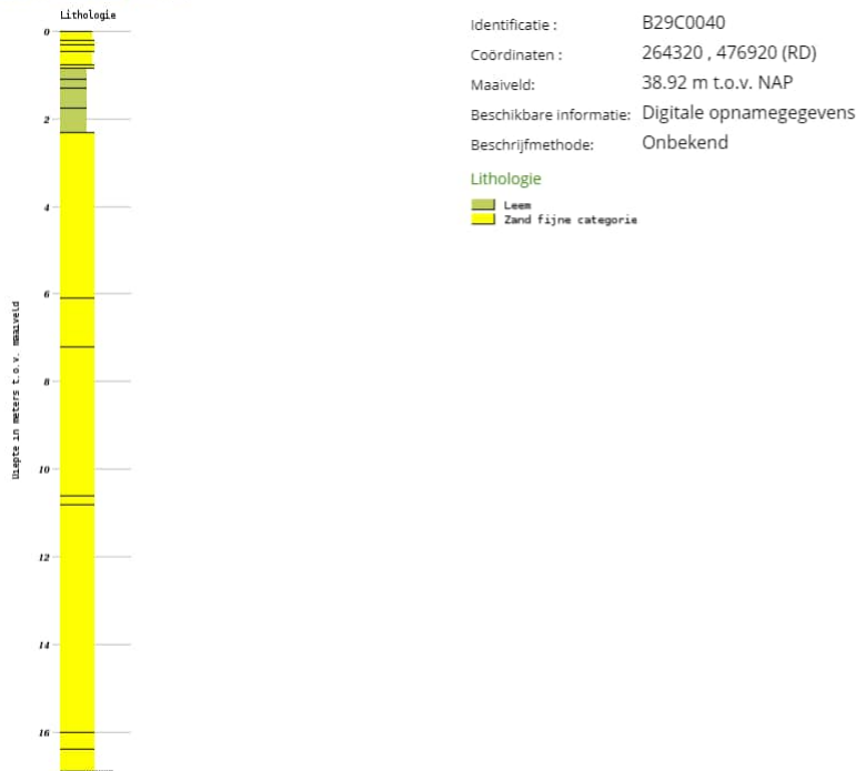
Afbeelding 2.1: Boorbeschrijving boring B29C0040 (bron: Dinoloket)
