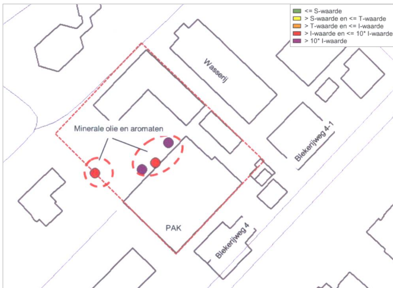
Afbeelding 6: Nevenverontreinigingen op de saneringslocatie (bron [8])
