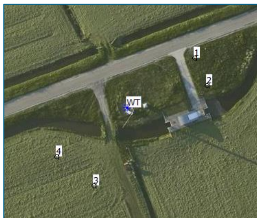
Afbeelding 3.2: Situering van de windturbine (WT) met punten waar de geluidmeter is geplaatst
