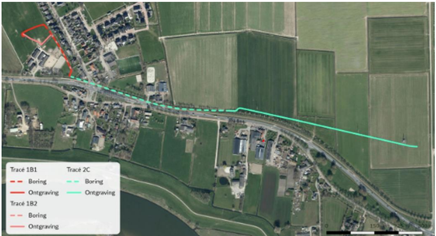
Figuur 4: Voorgenomen werkzaamheden (VKA, 2023).
