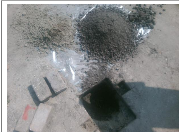
Foto: Inspectiegat E127 (20-50 cm -mv)
