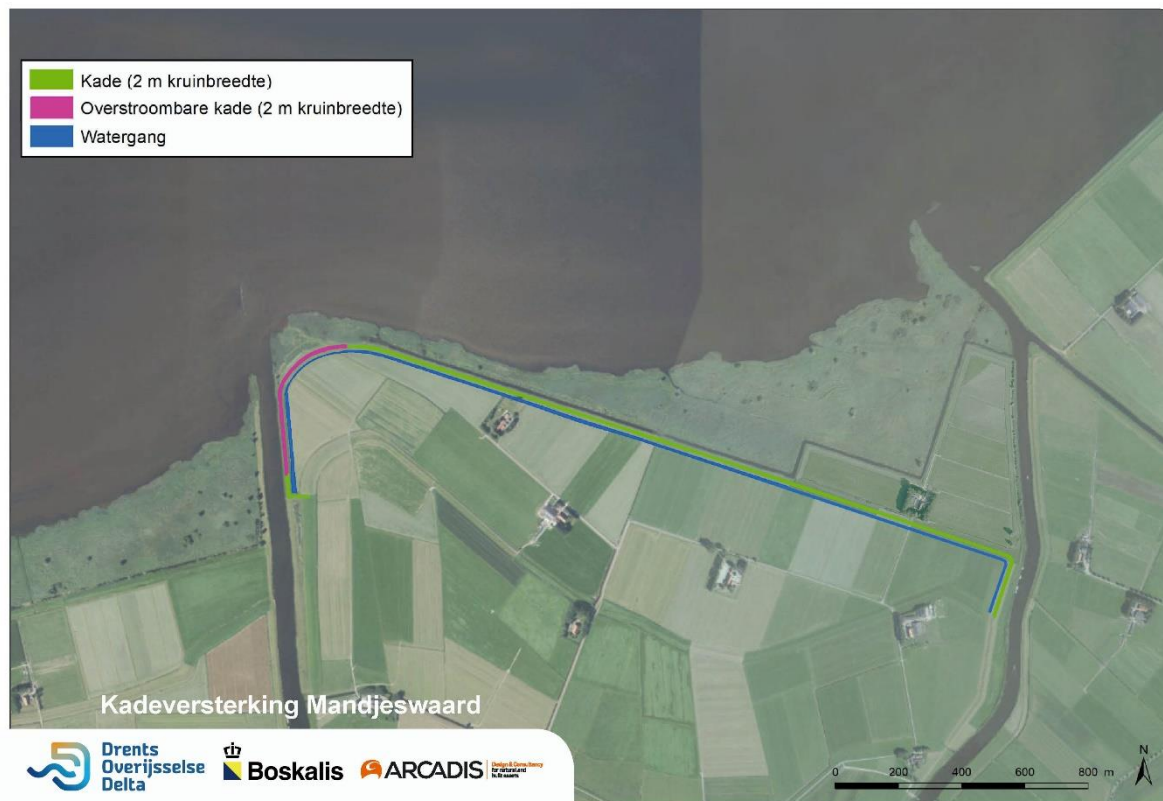
Figuur: Overzicht maatregelen in de Mandjeswaard (dijkkring 102). De groene lijn geeft de niet-overstroombare delen weer. De paarse lijn geeft het overstroombare deel weer. De nieuw te graven watergang loopt langs de binnenteen van de kering (donkerblauw).
