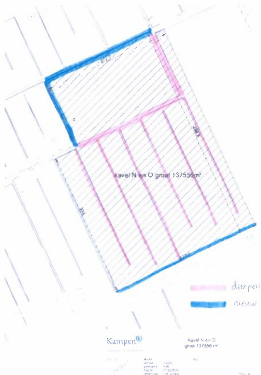
Figuur 1. Te dempen en te realiseren watergangen.
