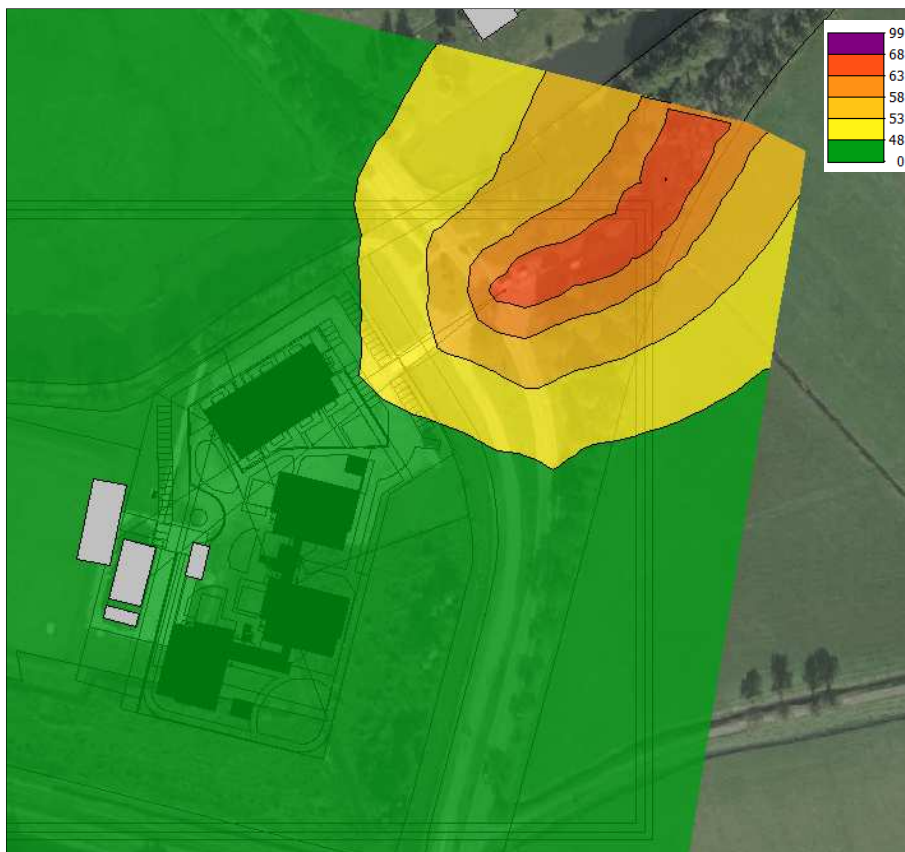
Figuur 4.3: Impressie van de geluidscontouren ten gevolge van de Veilingweg, waarneemhoogte 4,5 m, inclusief correctie conform artikel 110g
