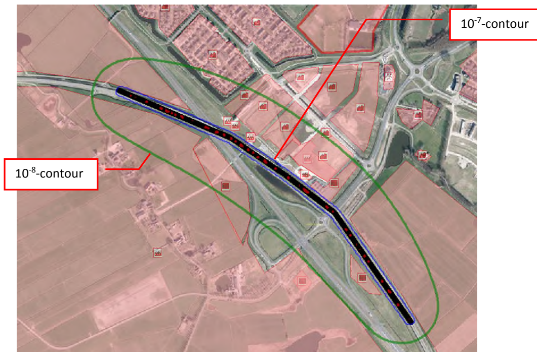
Figuur 4.1 Berekend plaatsgebonden risico Hanzelijn (output RBMII).
