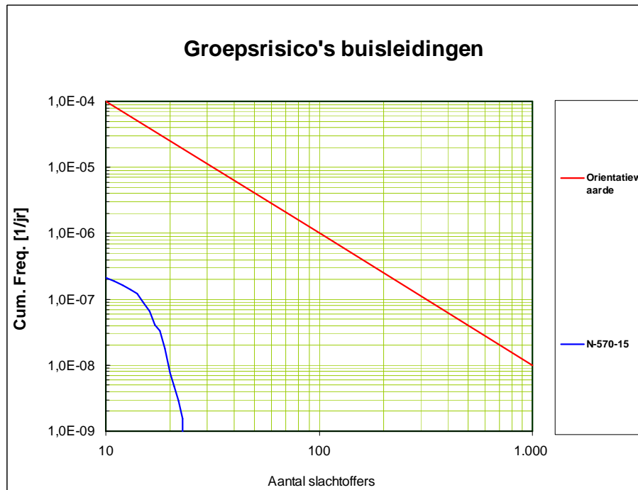
Figuur B3.15a fN-curve van aardgastransportleiding N570-15 ter hoogte van het bestemmingsplan Buitengebied
