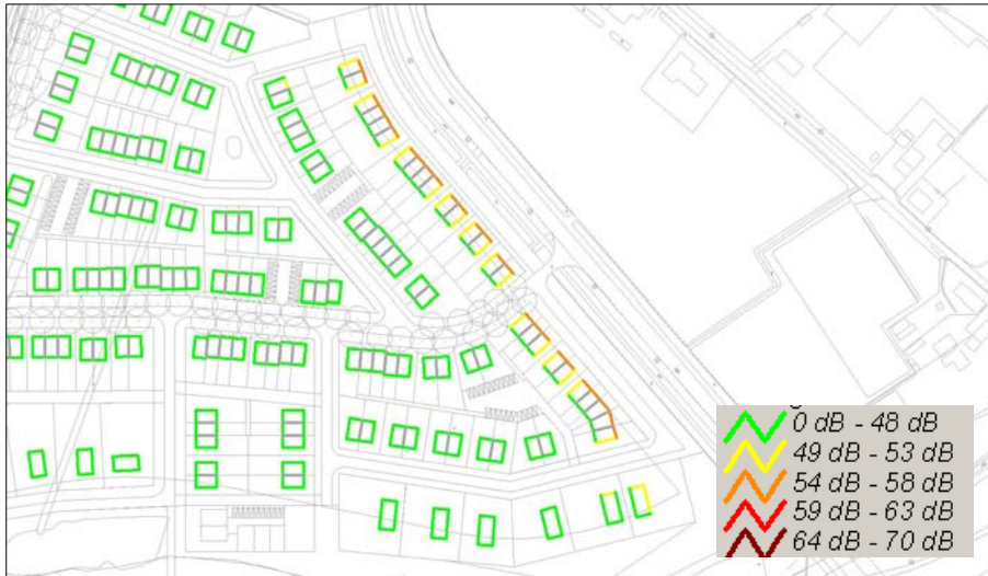
Figuur 3.12: Maatgevende geluidsbelasting op gevelniveau Plan Karen 2028 ten gevolge van de Oosterlandenweg
