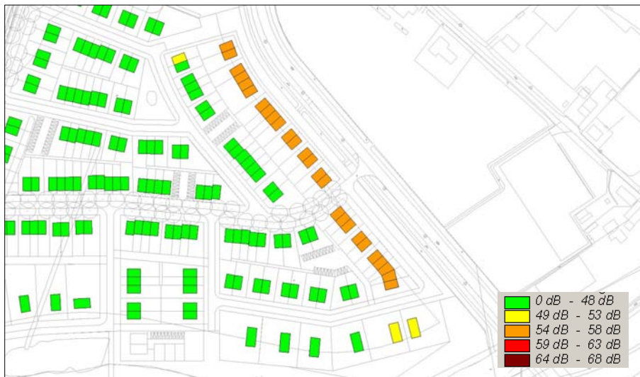
Figuur 3.6: Maatgevende geluidsbelasting per woning Plan Karen 2028 ten gevolge van de Oosterlandenweg
