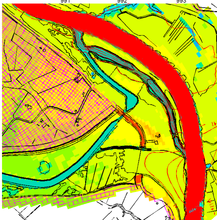
Figuur 12.1: Dwaarsstroming en afvoerlijnen fase 1 Onderdijkse Waard bij 8.000 m 3 /s voor het inrichtingsplan met optimalisatie bij de kade bij het defensie platform. Afvoerlijnen zijn per 10m 3 /s, maximaal stroomt er 45 m 3 /s door de Onderdijkse Waard.
