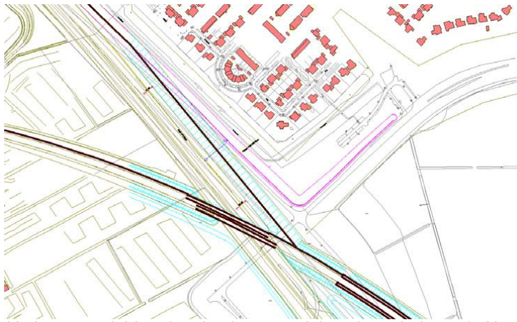
Verleggen geluidswal zodat deze aansluit op het talud van de Hanzelijn.
