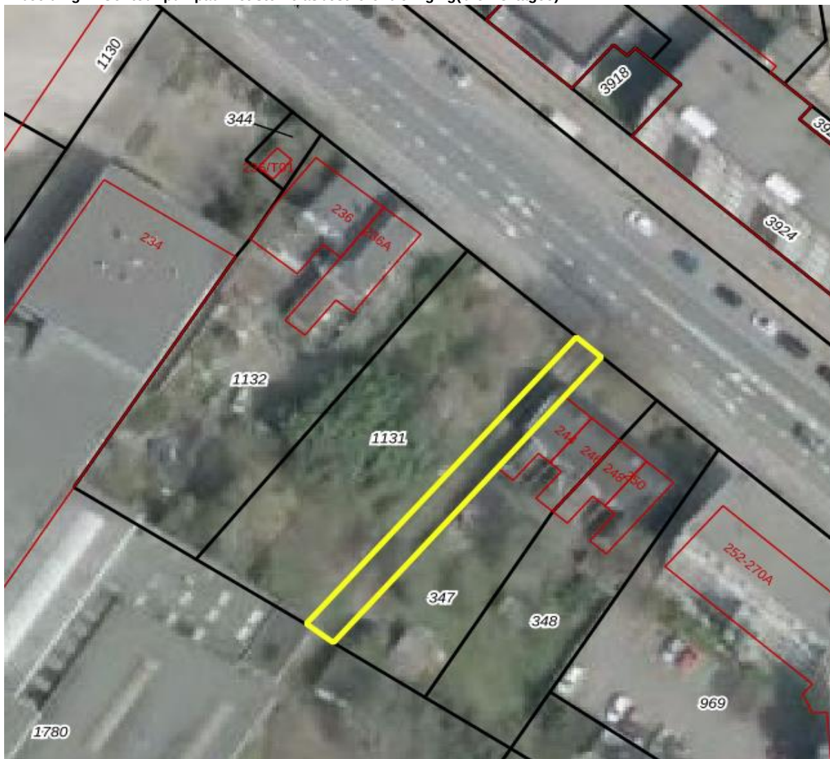
Afbeelding 2: Contour puinpad met sterke asbestverontreiniging(bron Ortagéo)
