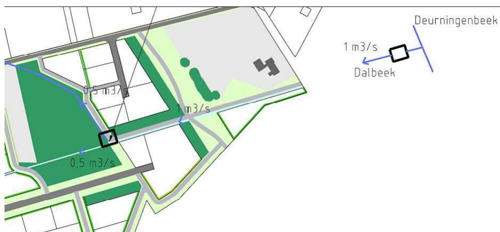
Figuur 4.2 Schematische situatie verdeelwerken
