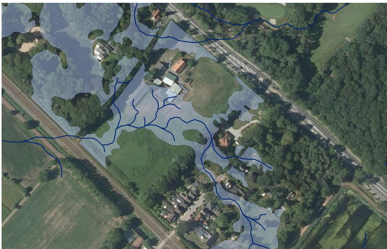
Overzicht van de ruimtelijke structuren en stroomdraden van het oorspronkelijke actieve watersysteem als sub stroom/kwelgebied van de Elsbeek (ondergrond luchtfoto 2019)
