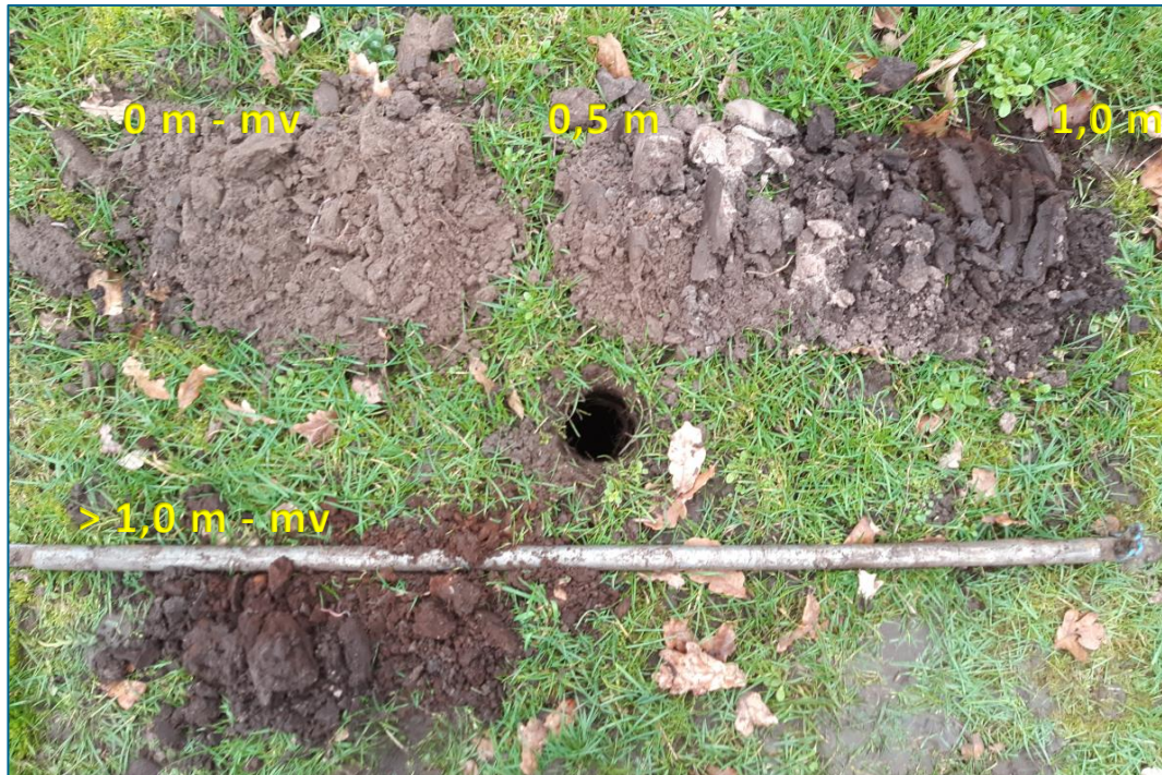
Abbeelding 6. Boring051A1 uitgelegd: linksboven 0 m –mv; rechtsboven 1 m –mv (scheiding op 0,5 m mv). Onder de staaf traject tot 1,05 m –mv). NB: het gedeelte dieper dan 1 m lijkt dikker doordat het steeds los schraapsel betreft (de boring kon door de verkitte roestlaag niet dieper worden doorgezet).
