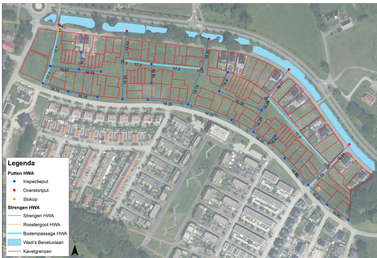
Figuur 10 Hoogteligging hemelwaterstelsel
