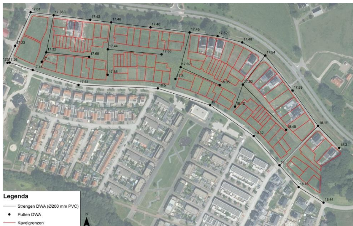
Figuur 5 Ligging DWA-riolen en minimale maaiveldhoogte
