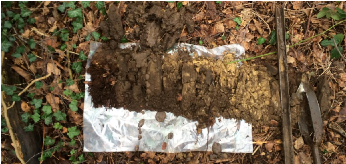
Opname van boring 5: diep omgewerkte bovengrond op dekzand
