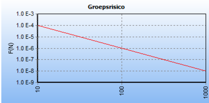
5.3 Figuur 5.3 FN curve voor 1516_leiding-N-528-91-deel-1 van N.V. Nederlandse Gasunie voor de kilometer tussen stationing 1610.00 en stationing 2610.00
