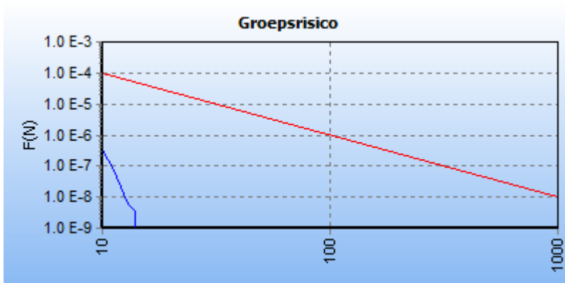
5.1 Figuur 5.1 FN curve voor 872_leiding-A-508-deel-1 van N.V. Nederlandse Gasunie voor de kilometer tussen stationing 2960.00 en stationing 3960.00
