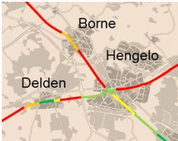
Figuur 4.1: Uitsnede van de bestrijdbaarheidskaart spoortrajecten Twente. Schaal loopt van groen (voldoende) via lichtgroen/geel/oranje tot rood (onvoldoende). Bron: Veiligheid spoor Twente (Veiligheidsregio Twente, mei 2013)
