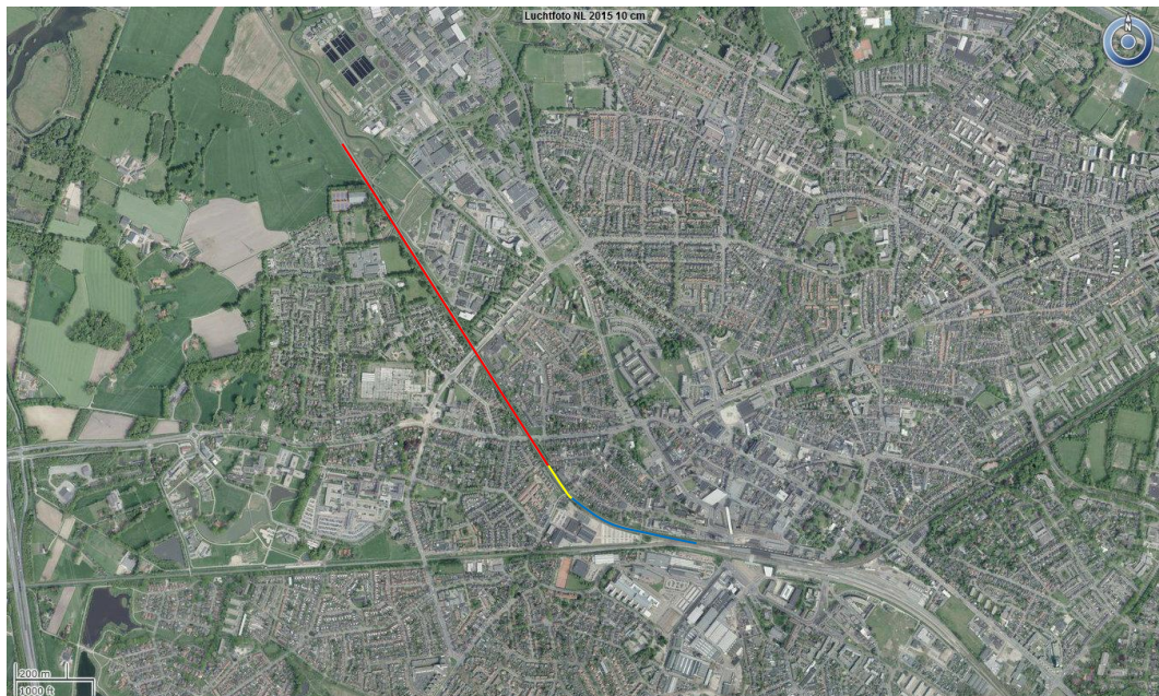
Figuur B1.1: Onderzocht spoortraject (rood: zonder wissels; hoge snelheid, geel: met wissels; hoge snelheid; blauw: met wissels; lage snelheid)
