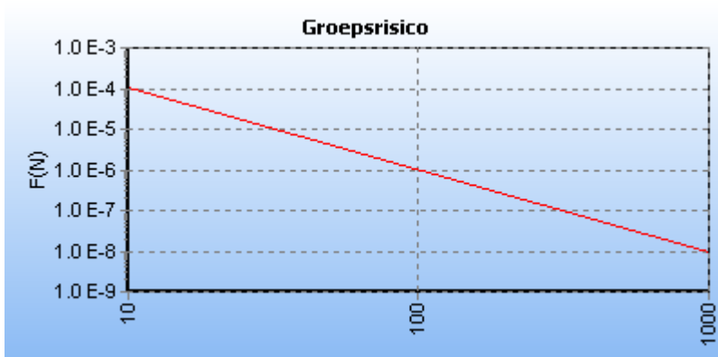
5.1 Figuur 5.1 FN curve voor N-528-66 van N.V. Nederlandse Gasunie voor de kilometer tussen stationing 0.00 en stationing 1000.00
