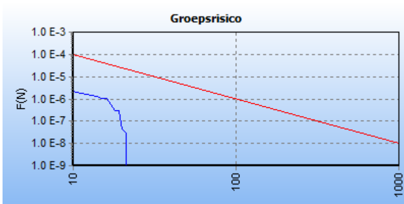
5.2 Figuur 5.2 FN curve voor 598_leiding-N-528-70-deel-1 van N.V. Nederlandse Gasunie voor de kilometer tussen stationing 3520.00 en stationing 4520.00
