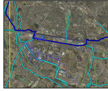
Gasleiding 6 inch/40 bar
