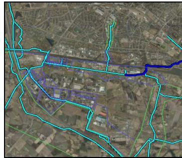
Gasleiding 8 inch/ 40 bar
