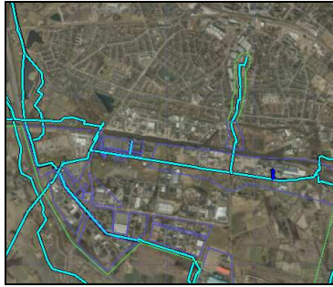
Gasleiding 6 inch/40 bar
