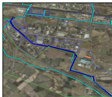
Gasleiding 12 inch/40 bar
