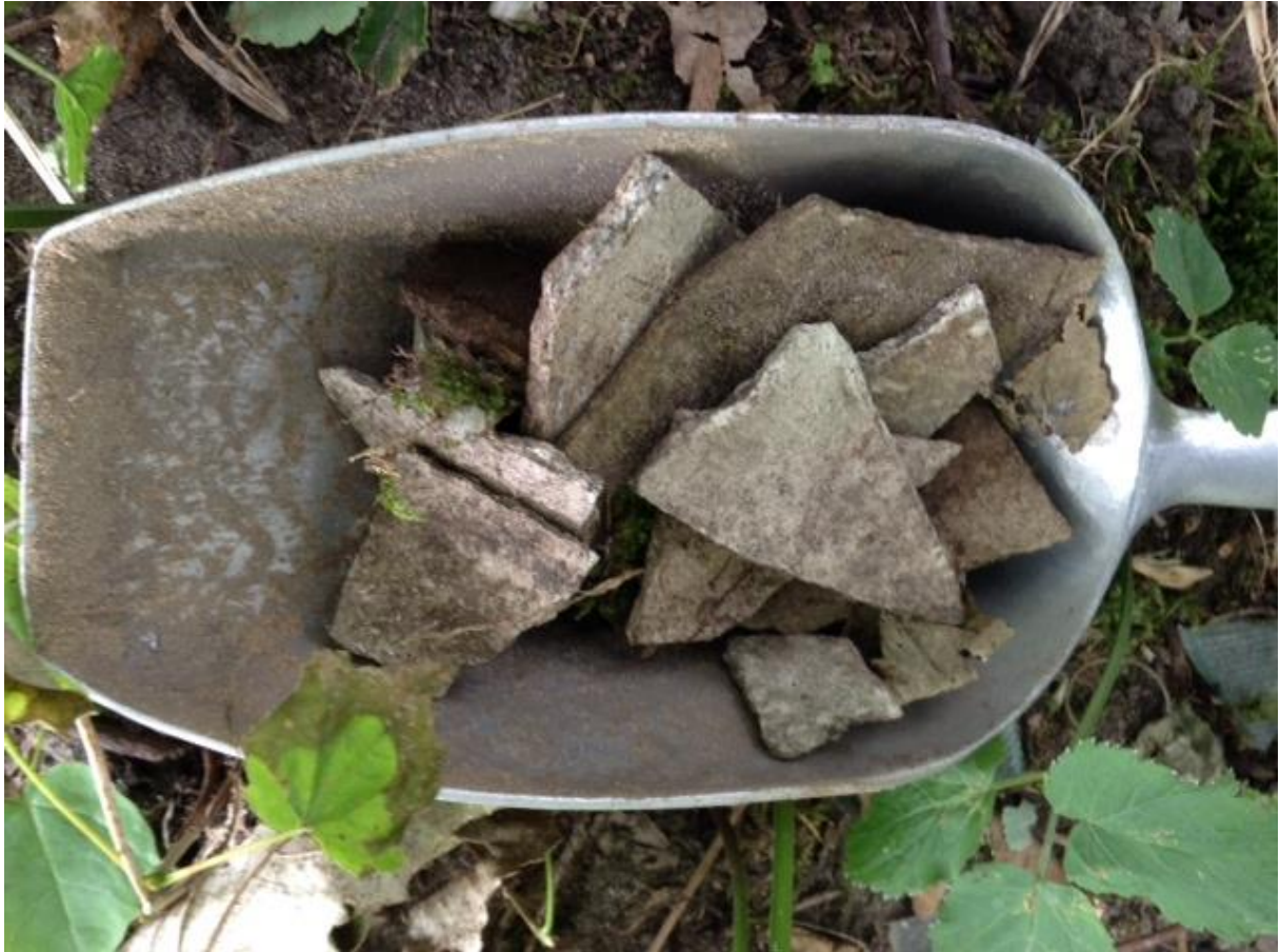
Foto 4: asbestplaatjes uit G8
