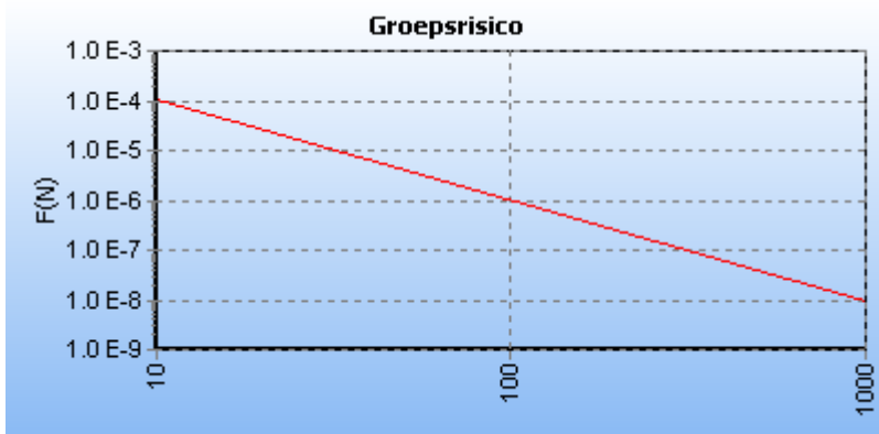
5.3 Figuur 5.3 FN curve voor A-806 van N.V. Nederlandse Gasunie voor de kilometer tussen stationing 2960.00 en stationing 3960.00
