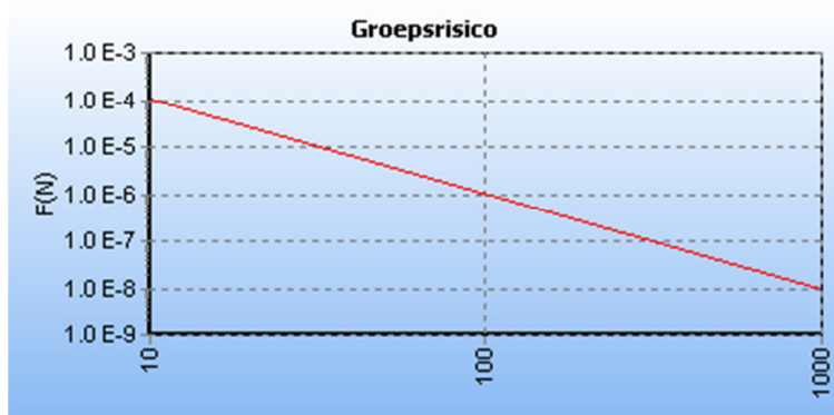
5.2 Figuur 5.2 FN curve voor A-529 van N.V. Nederlandse Gasunie voor de kilometer tussen stationing 10760.00 en stationing 11760.00
