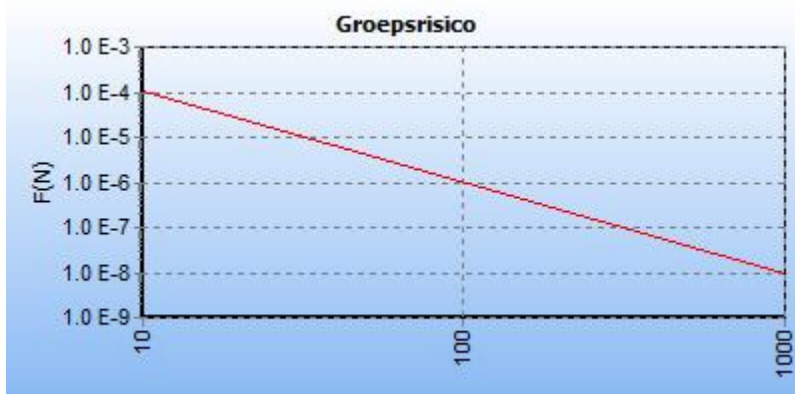
5.3 Figuur 5.3 FN curve voor A-648 van N.V. Nederlandse Gasunie voor de kilometer tussen stationing 14210.00 en stationing 15210.00
