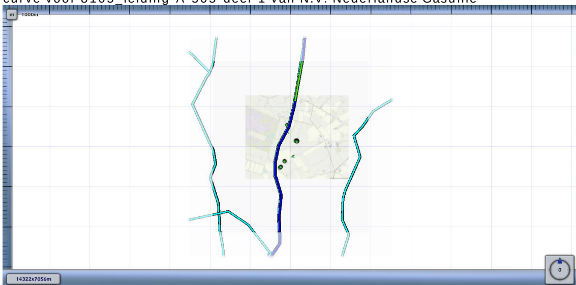
Figuur 4.1 Kilometer leiding behorende bij de maximale overschrijding van de FN-curve voor 8105_leiding-A-505-deel-1 van N.V. Nederlandse Gasunie
