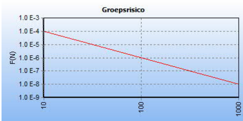
5.2 Figuur 5.2 FN curve voor 8105_leiding-A-506-deel-1 van N.V. Nederlandse Gasunie voor de kilometer tussen stationing 630.00 en stationing 1630.00
