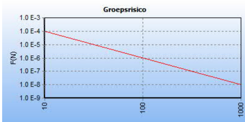
5.7 Figuur 5.7 FN curve voor 8105_leiding-A-529-deel-1 van N.V. Nederlandse Gasunie voor de kilometer tussen stationing 800.00 en stationing 1800.00
