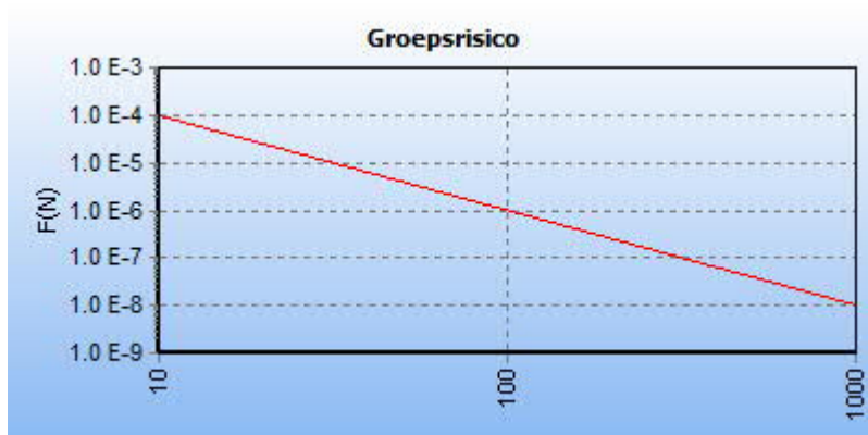
5.5 Figuur 5.5 FN curve voor 8105_leiding-A-522-deel-1 van N.V. Nederlandse Gasunie voor de kilometer tussen stationing 630.00 en stationing 1630.00
