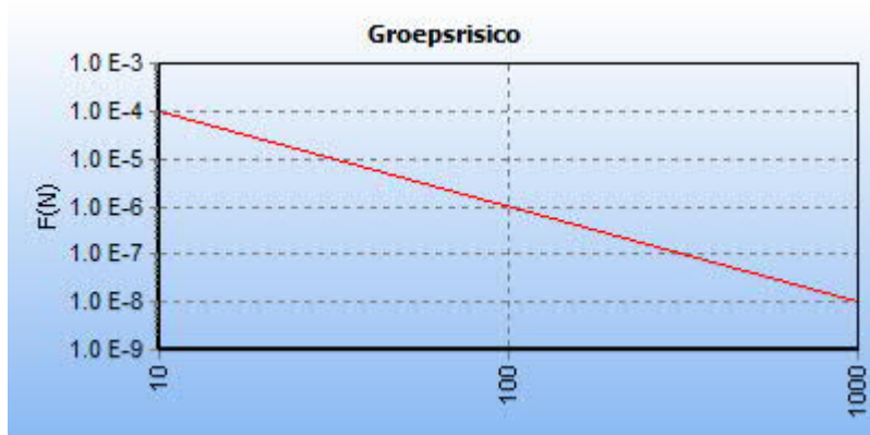
5.10 Figuur 5.10 FN curve voor 8105_leiding-A-662-deel-1 van N.V. Nederlandse Gasunie voor de kilometer tussen stationing 630.00 en stationing 1630.00
