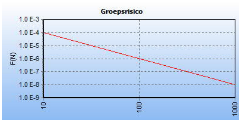
5.8 Figuur 5.8 FN curve voor 8105_leiding-A-549-deel-1 van N.V. Nederlandse Gasunie voor de kilometer tussen stationing 630.00 en stationing 1630.00
