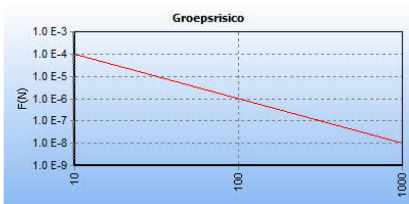
5.11 Figuur 5.11 FN curve voor 8105_leiding-N-557-26-deel-1 van N.V. Nederlandse Gasunie voor de kilometer tussen stationing 0.00 en stationing 0.00
