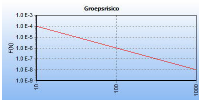
5.14 Figuur 5.14 FN curve voor 8105_leiding-N-557-36-deel-1 van N.V. Nederlandse Gasunie voor de kilometer tussen stationing 0.00 en stationing 0.00
