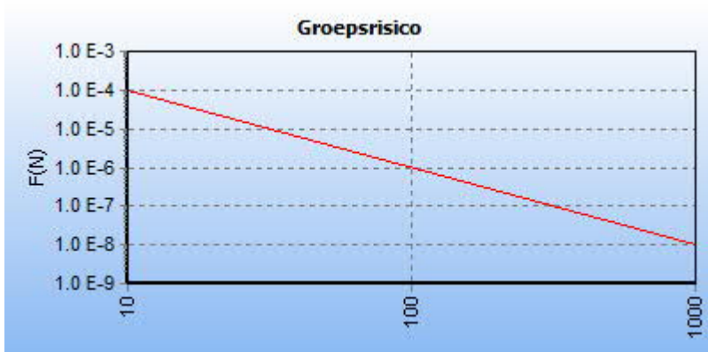
5.2 Figuur 5.2 FN curve voor 8105_leiding-A-506-deel-1 van N.V. Nederlandse Gasunie voor de kilometer tussen stationing 630.00 en stationing 1630.00
