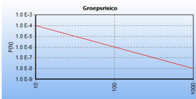
5.13 Figuur 5.13 FN curve voor 8105_leiding-N-557-30-deel-1 van N.V. Nederlandse Gasunie voor de kilometer tussen stationing 630.00 en stationing 1630.00
