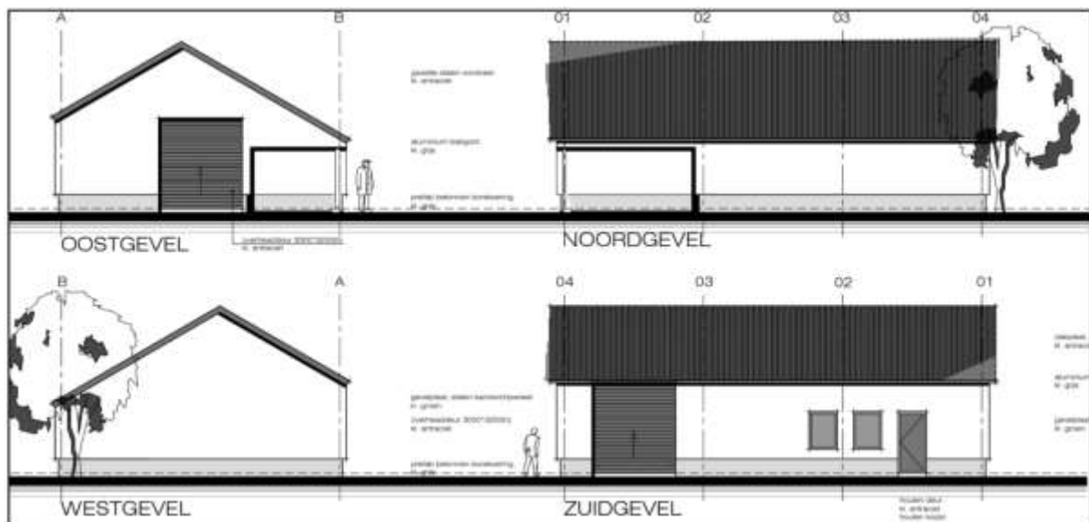
Afbeelding 2.4 Tekening gevelaanzichten gewenste schuur (Bron: Gert Smit / de bouwkunst)
