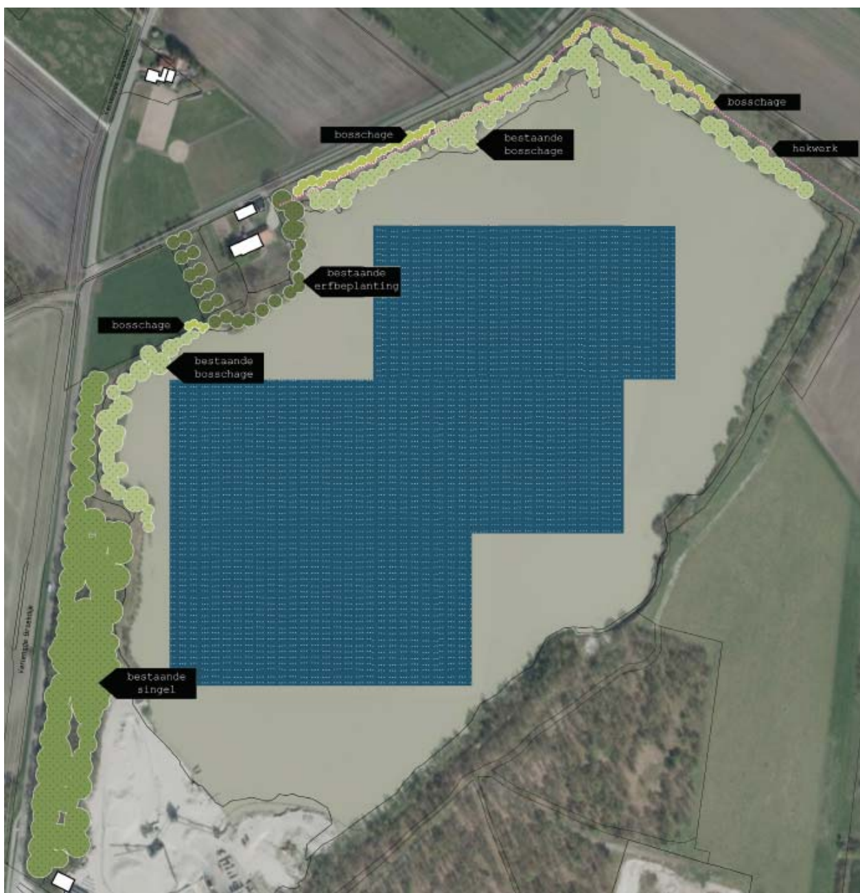
Figuur 2.2: Lay-out van het drijvende zonnepark (bovenaanzicht).
