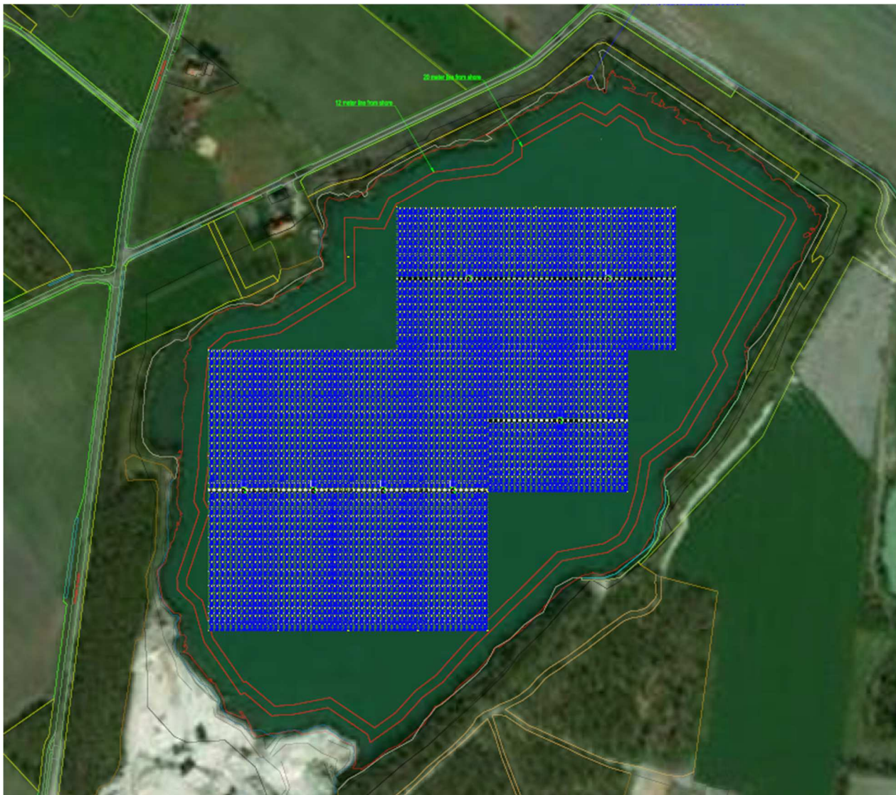
Figuur 2.2: Lay-out van het drijvende zonnepark (bovenaanzicht).
