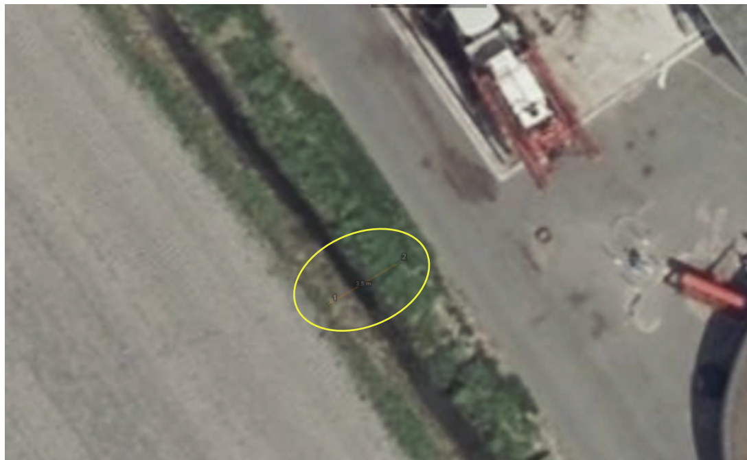
Figuur 8: breedte van de sloot ter hoogte van achterkant spoelplaats (gemeten in Cyclomedia)
