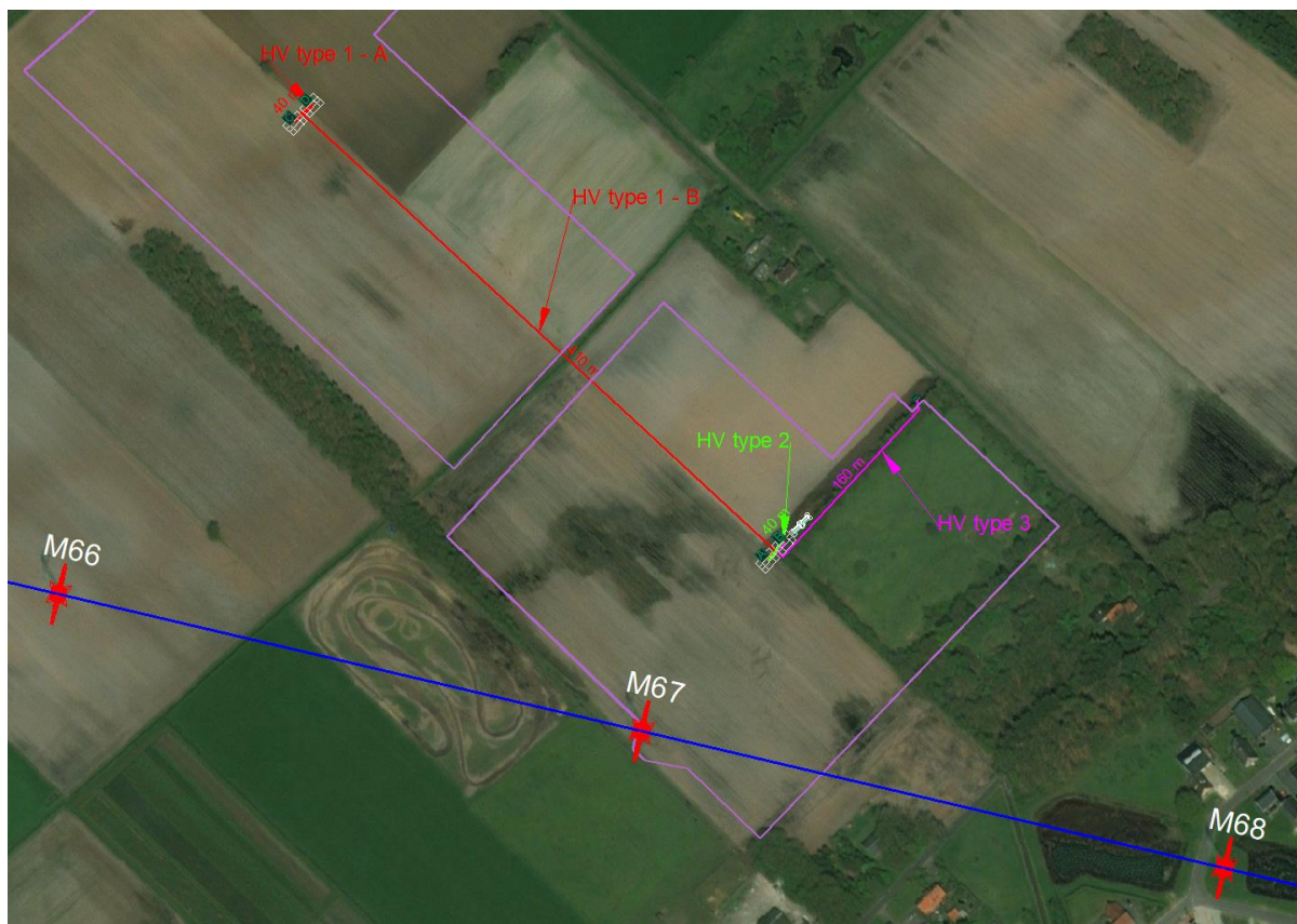
Figuur 1, Bovenaanzicht hoogspanningslijn en middenspanningskabels
