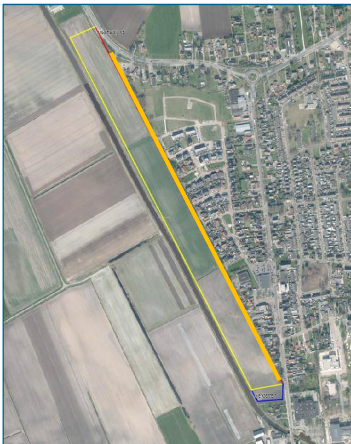
Figuur 3.4. Modificatie 13. Rood: te verwijderen leiding. Geel: aan te leggen leiding. Oranje: trekken van bestaande leiding om bomen te besparen. Blauw: werkterrein (30x30 meter).
