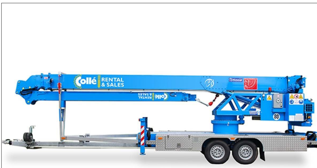
Voorbeeld van een lichte, mobiele kraan. Geschikt voor plaatsen gevelbekleding, aanreiken van dakpannen en gordingen.
