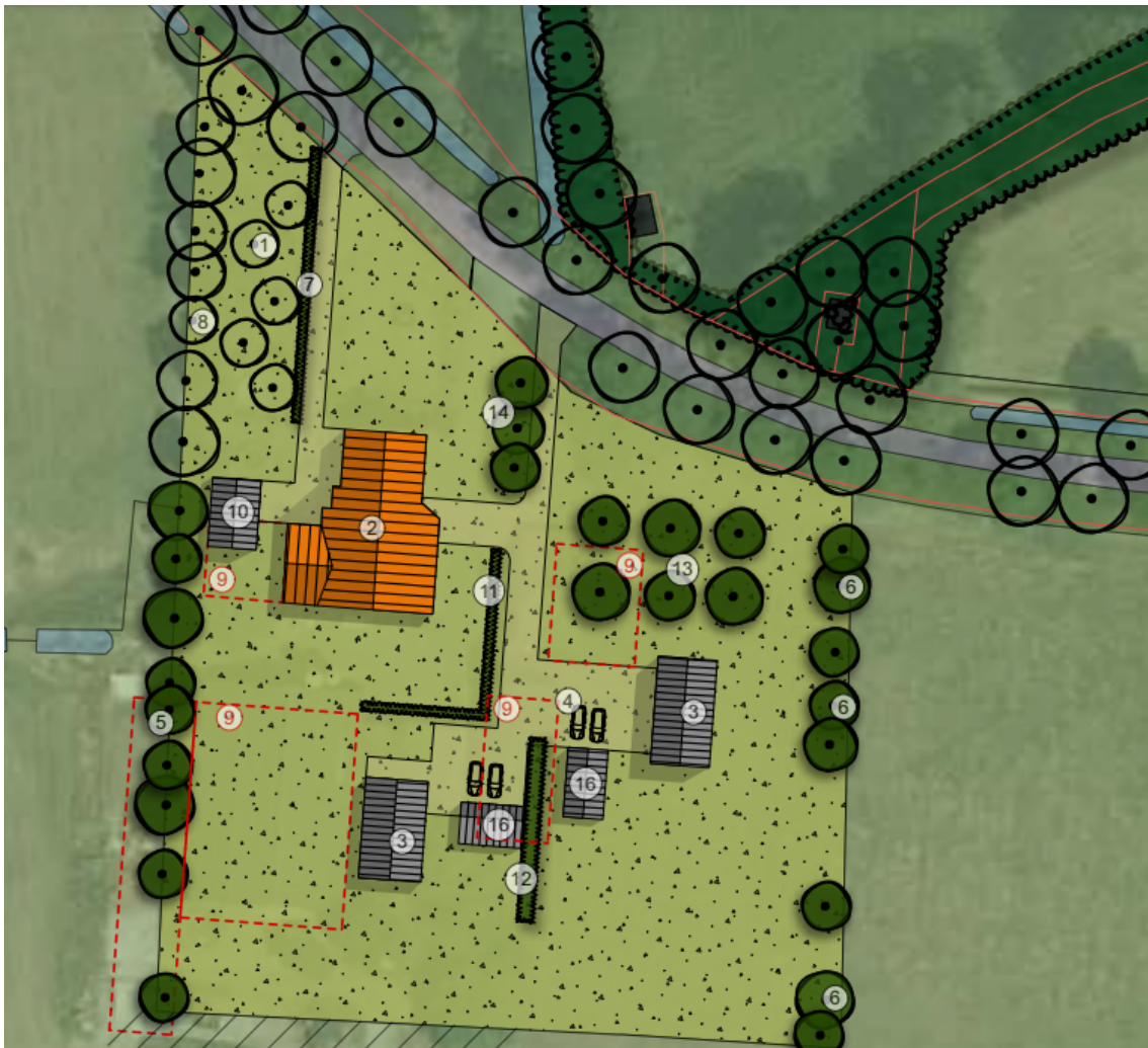
Afbeelding 1 Ligging plangebied Stobbenhaarweg 7 Radewijk, te slopen bebouwing (rode stippellijn), de twee nieuwe schuurwoningen (nummers 3) en de te splitsen bestaande boerderij (nummer 2)
