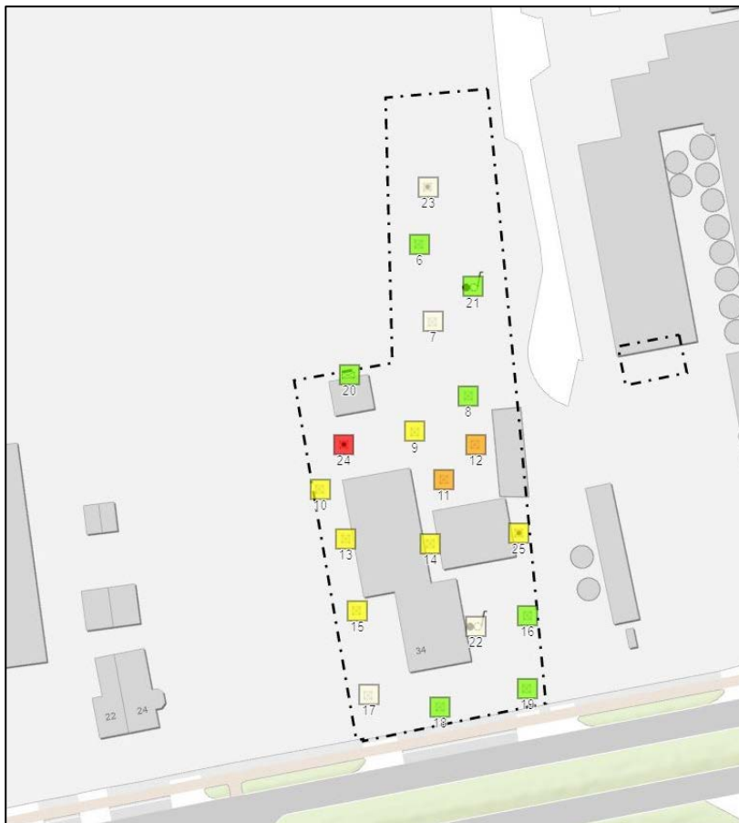
Figuur 4.1 Overzicht van bijmengingen over het volledige bodemtraject (legenda monsterpunten; groen = geen waarneming, lichtgeel = zeer licht, geel = licht, oranje = matig, rood = sterk en paars = zeer sterk)
