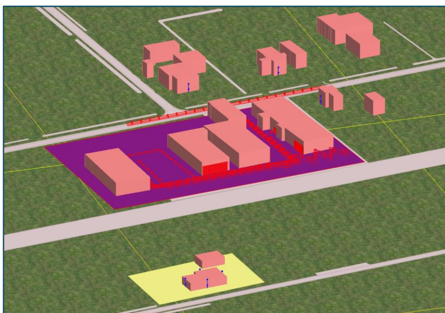
Figuur 2 Impressie rekenmodel industrielawaai vanwege van de Peppel.
